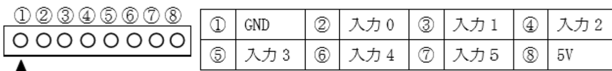
図2 ケーブルA用ピンヘッダピン配置図
