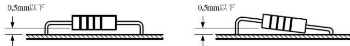
図2 部品の浮き上がり
